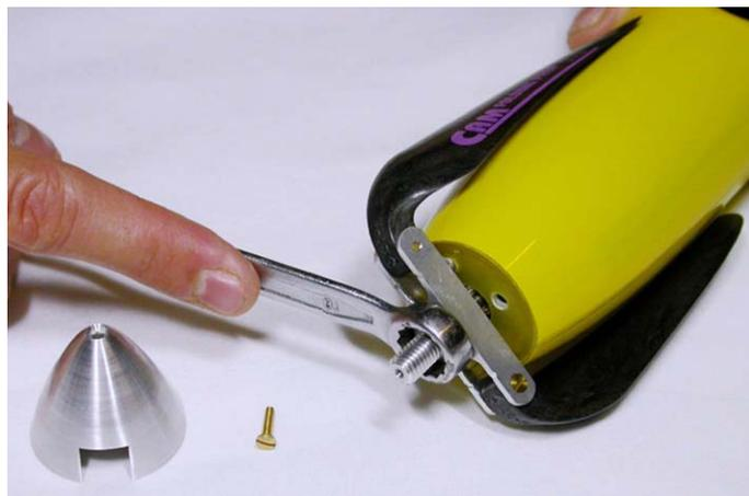
*Fig.17: Serrare l'elica sull'albero motore.*
