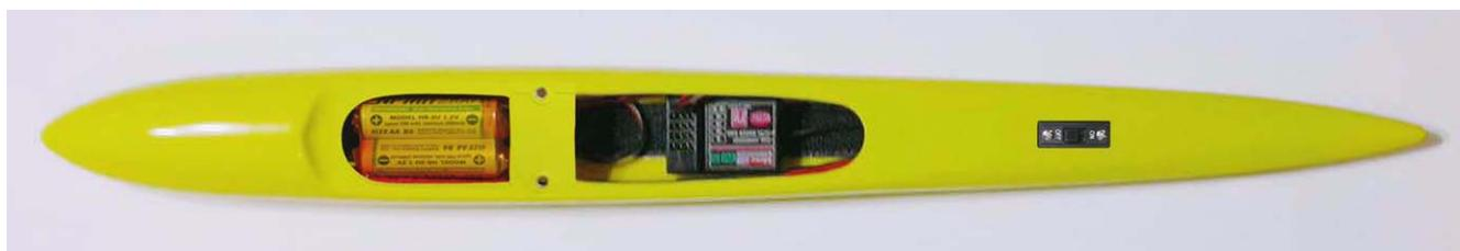
**Fig.31: Disposizione dei componenti nella versione aliante.**
