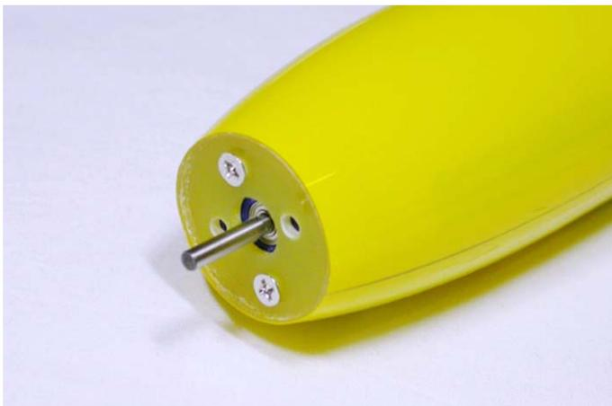
*Fig.15: Avvitare il motore alla struttura.*
