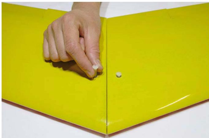
*Fig.68: Inserire le viti di Nylon.*
