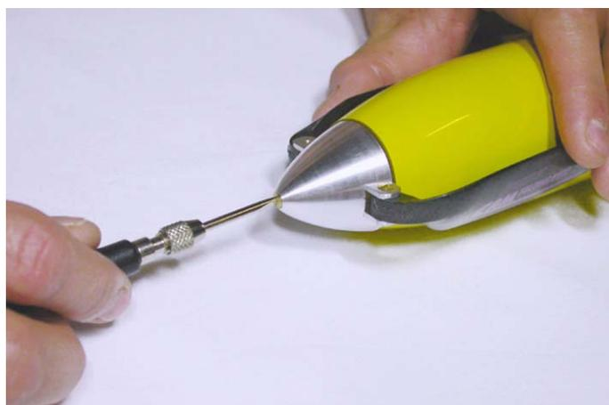
*Fig.18: Fissare l'ogiva al mozzo.*
