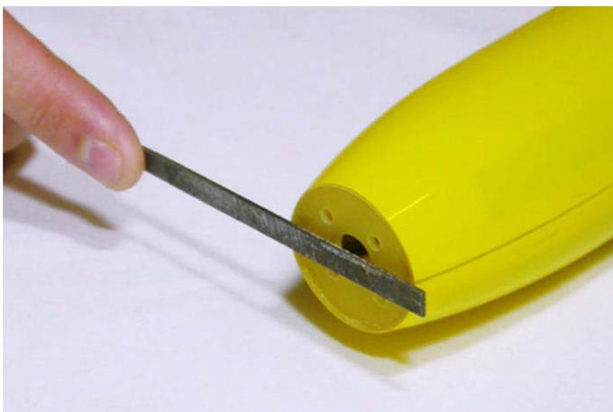
**Fig.6: Rifinire il bordo della fusoliera.**
