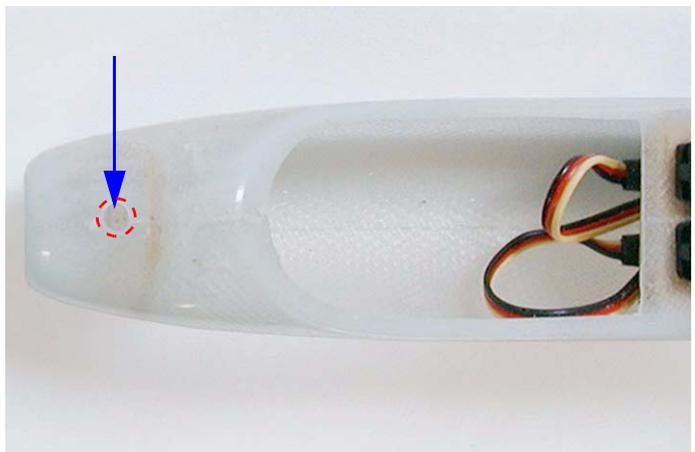
**Fig.8: Foro per l'inserimento del piombo.**
