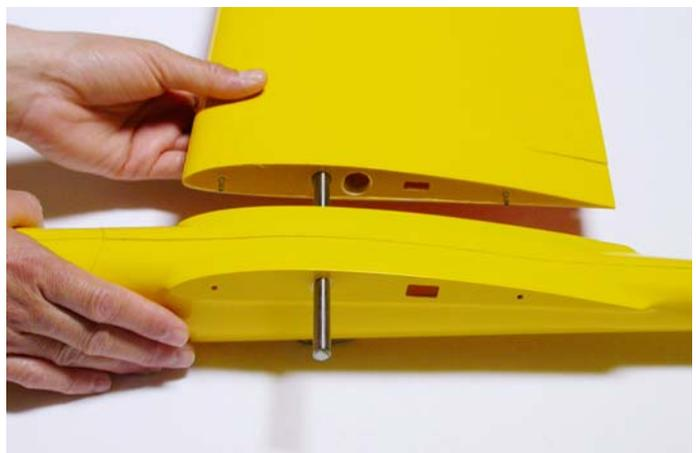
*Fig.14: Infilare una semi-ala.*
