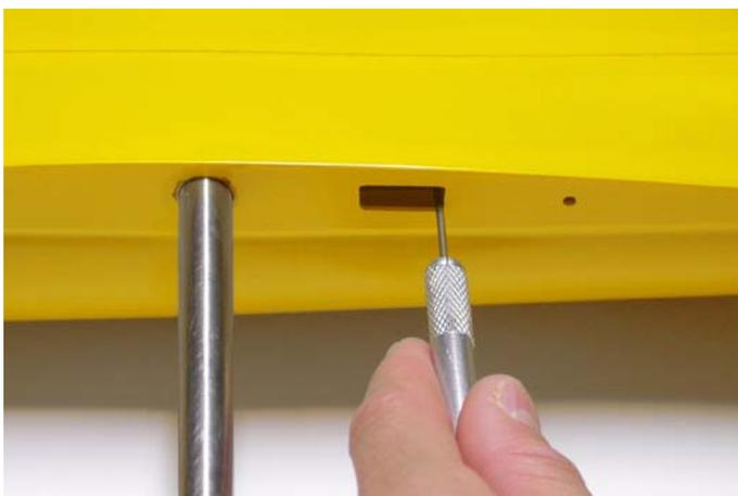
*Fig.37: Riportare il contorno del foro sull'ala.*
