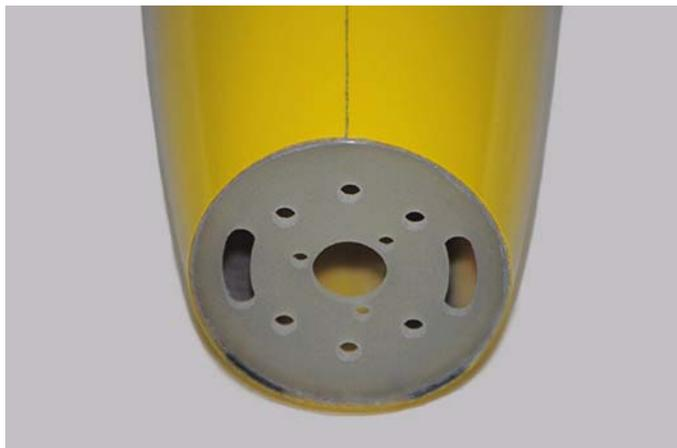
Fig.4: Ordinata del motore in posizione.
