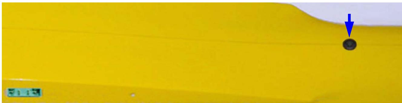
*Fig.103: Posizione del foro per l'antenna.*
