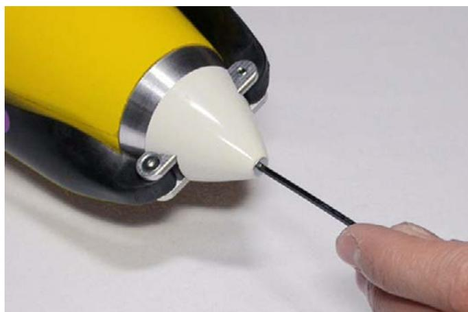
**Fig.28: Avvitare la vite di bloccaggio dell'ogiva.**
