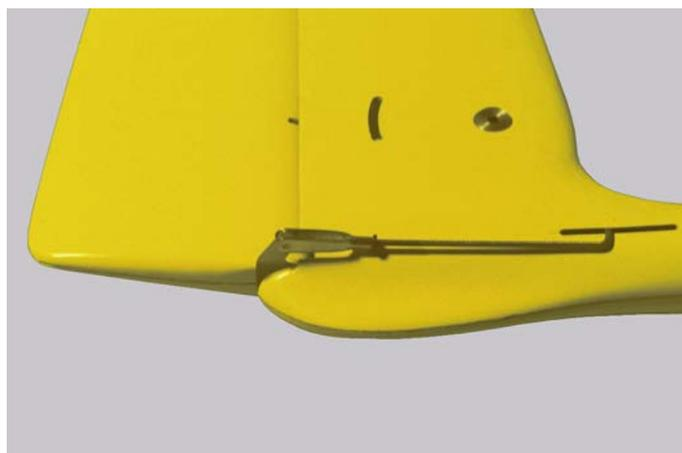
**Fig.83: Collegamento alla squadretta per la movimentazione della deriva.**
