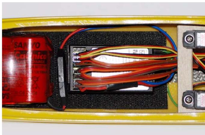
**Fig.45:Collegare i connettori all'apparato ricevente.**
