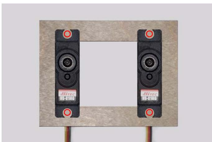
Fig.6: inserire i servocomandi nella basetta.
