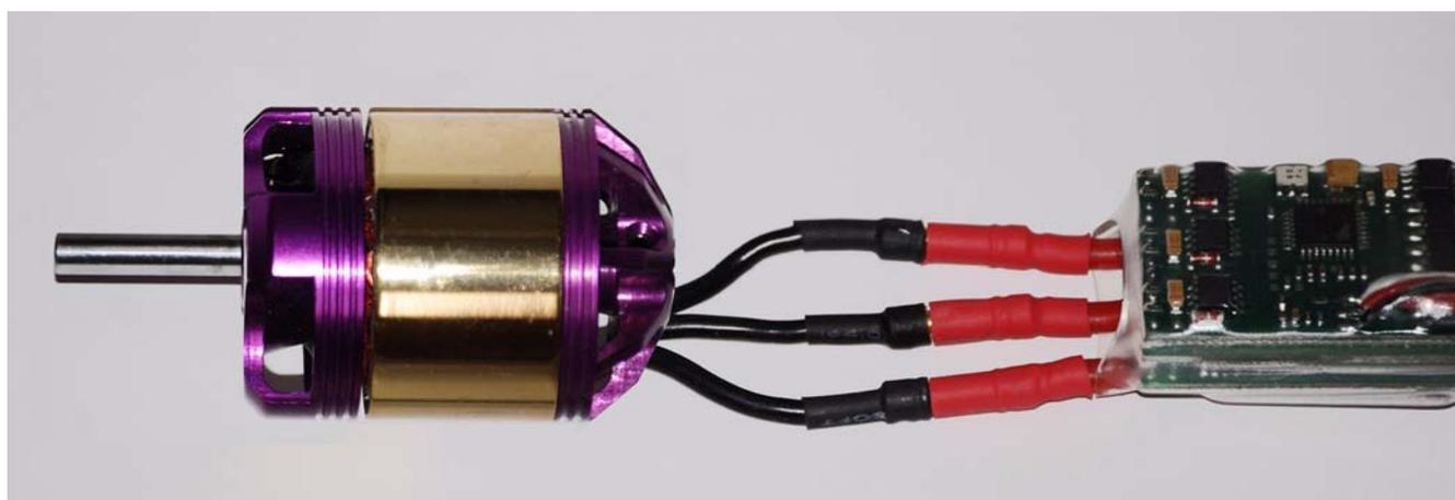
**Fig.21: Collegamento del motore brushless.**
