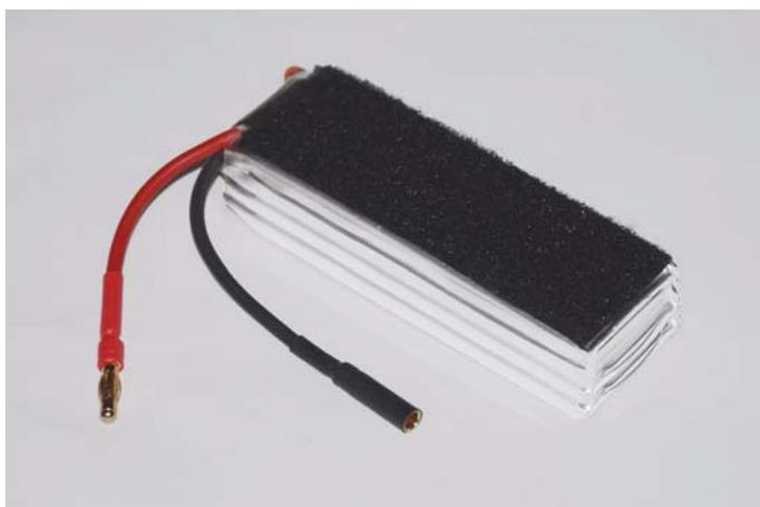
*Fig.24: Posizione del velcro sul pacco di batterie.*
