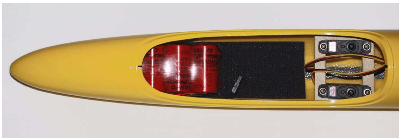
*Fig. 17: Pacco batterie in posizione.*
