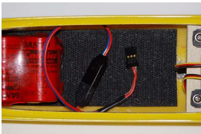
*Fig. 18: Connessioni del pacco di batterie.*
