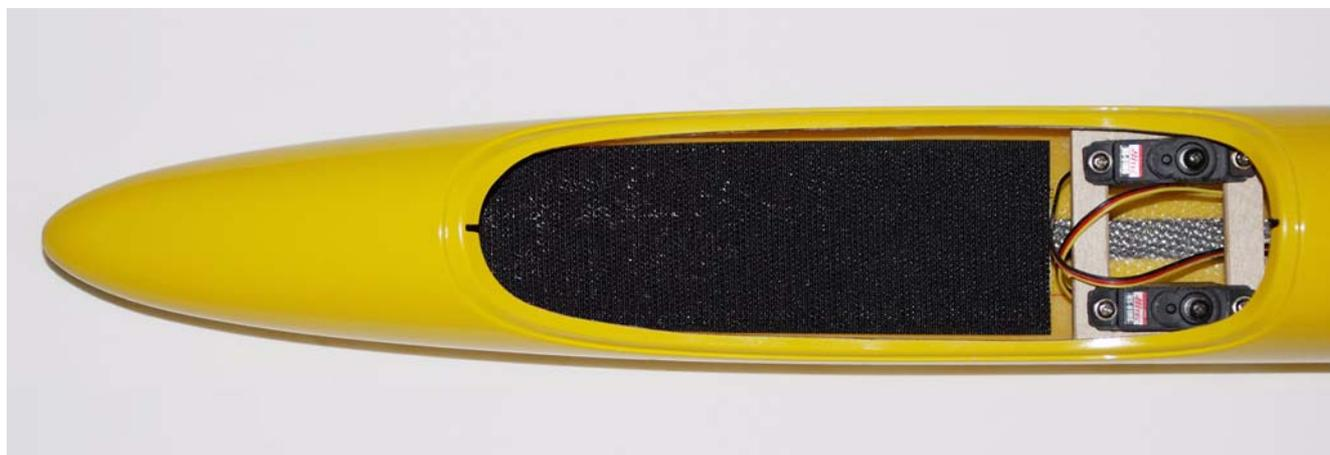
*Fig.12: Posizionamento della bassetta di supporto in fusoliera.*
