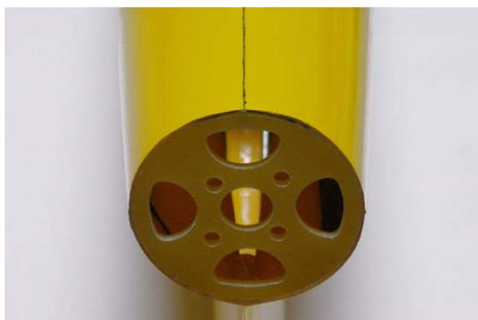
Fig. 16: Ordinata motore in posizione.
