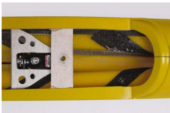
**Fig.28: Basetta in posizione.**
