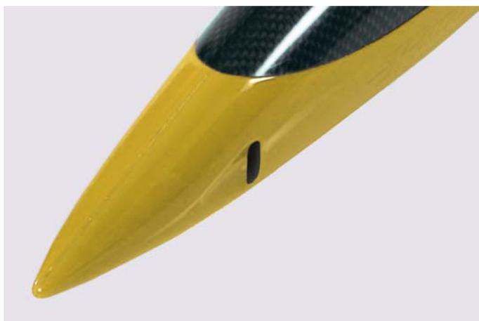
*Fig.42: Apertura dei fori per il raffreddamento.*
