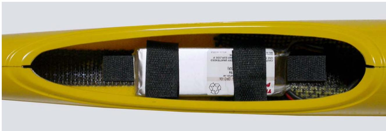
**Fig.26: Inserimento e ancoraggio del pacco batterie.**
