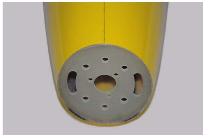
**Fig.35:** Ordinata del motore in posizione.
