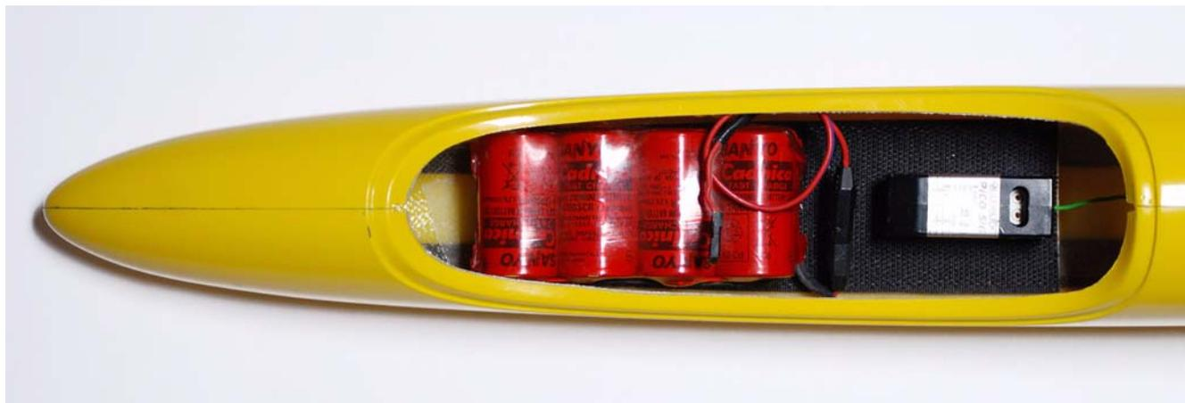
*Fig.44: Apparato ricevente in posizione.*
