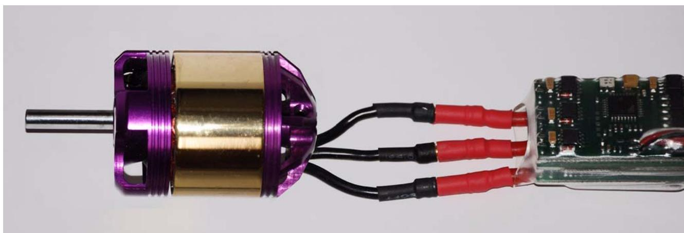
**Fig.49: Collegamento del motore brushless.**
