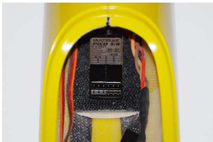
*Fig.65: Posizione dell'apparato ricevente.*
