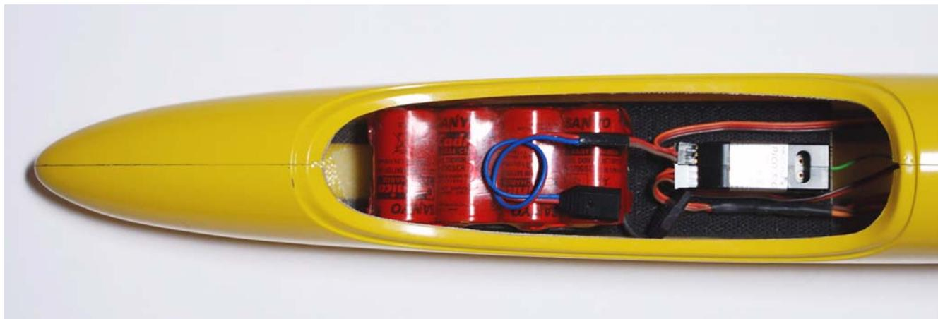
*Fig.64: Collegamenti dell'apparato ricevente (versione veleggiatore).*
