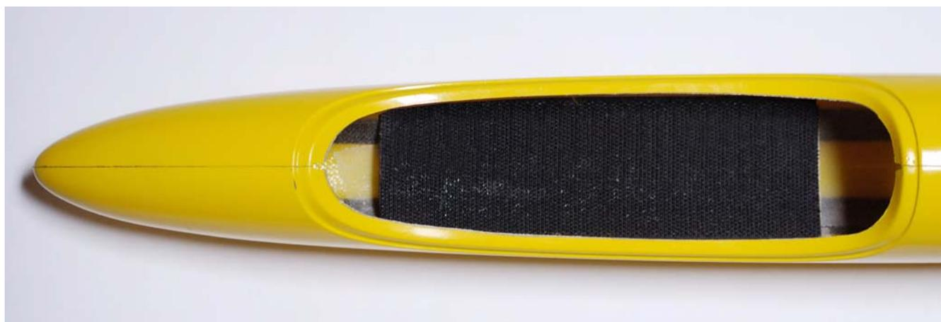
*Fig.38: Posizionamento della basetta di supporto in fusoliera.*
