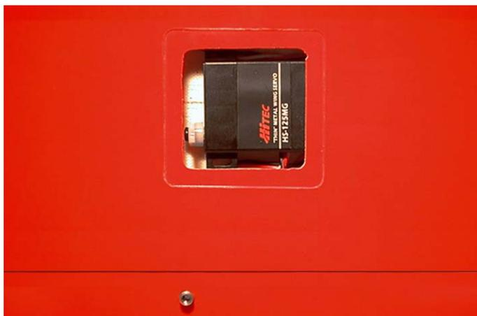
Fig.82:Alloggiamento del servocomando.
