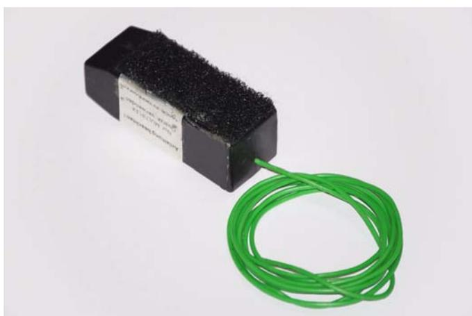
**Fig.43: Posizione del velcro sull'apparato ricevente.**
