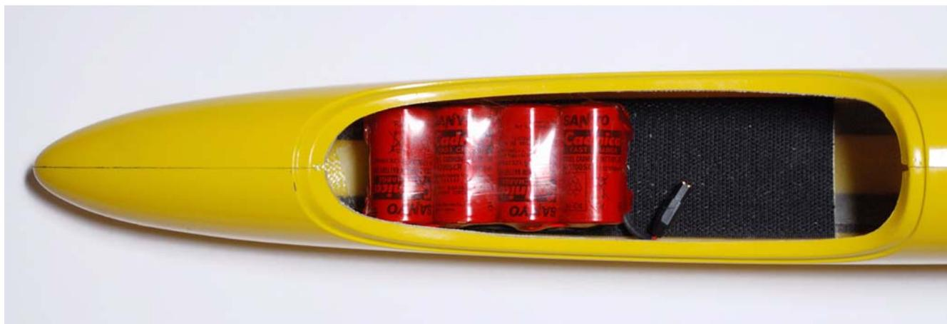
**Fig.41: Pacco batterie in posizione.**
