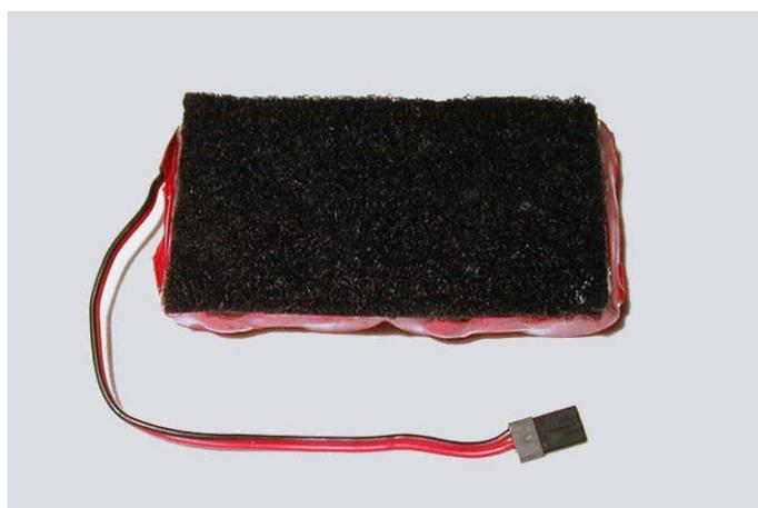
**Fig.40: Posizione del velcro sul pacco di batterie.**
