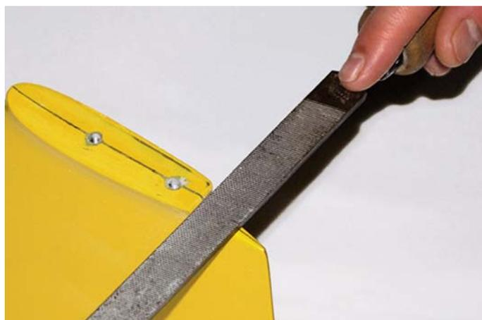
*Fig.3: Asportare la parte terminale della deriva.*
