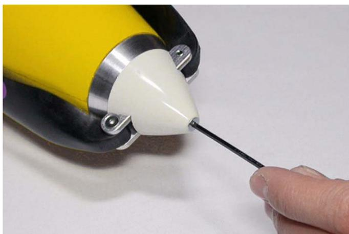
*Fig.56: Avvitare la vite di bloccaggio dell'ogiva.*
