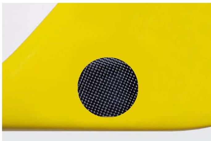
**Fig.29: Chiudere il foro d'accesso al servocomando.**
