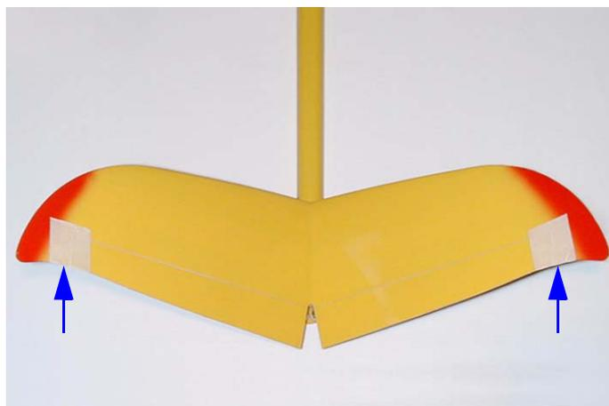
**Fig.69: Tenere allineate le superfici mobili della coda.**
