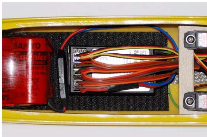
**Fig.46:Collegare i connettori all'apparato ricevente.**
