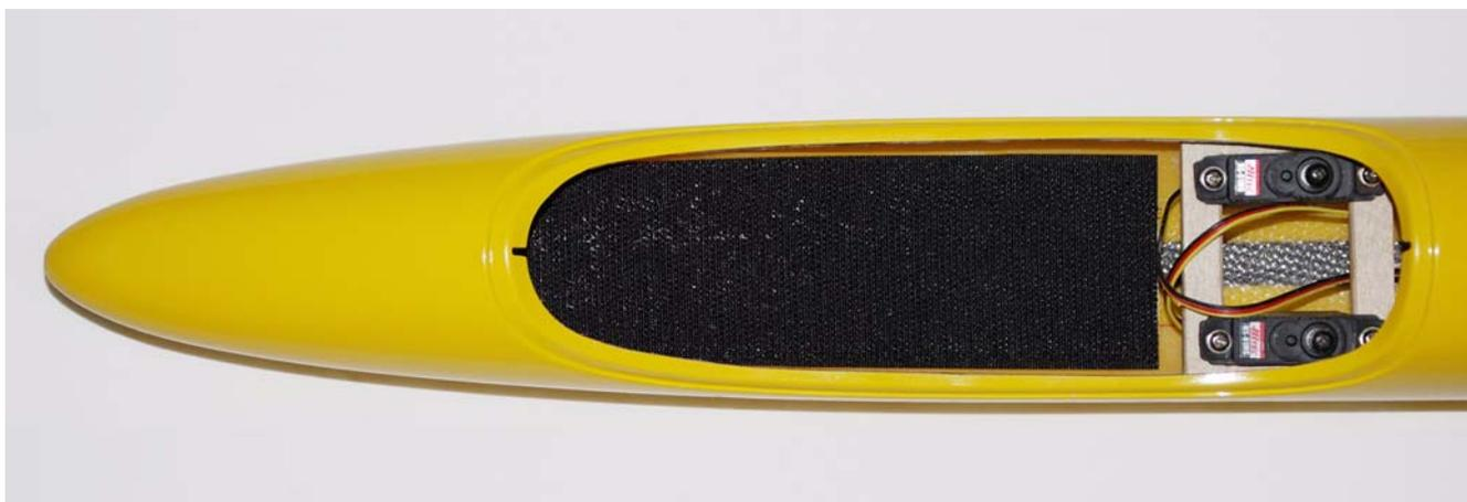
*Fig.13: Posizionamento della basetta di supporto in fusoliera.*
