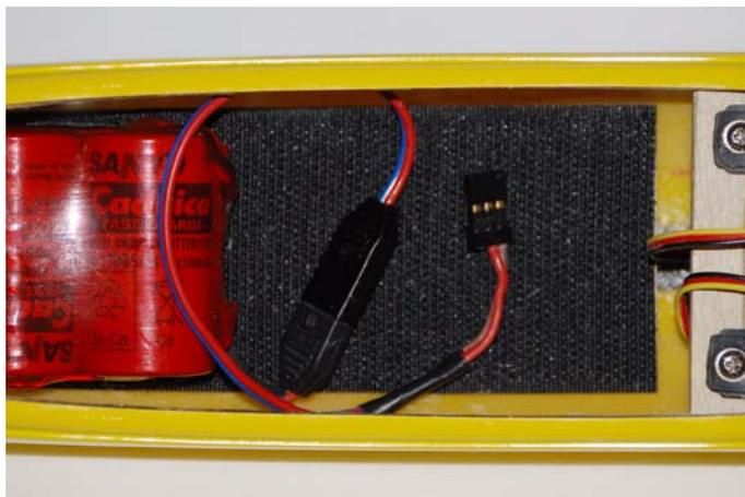
*Fig.19:Connessioni del pacco di batterie.*
