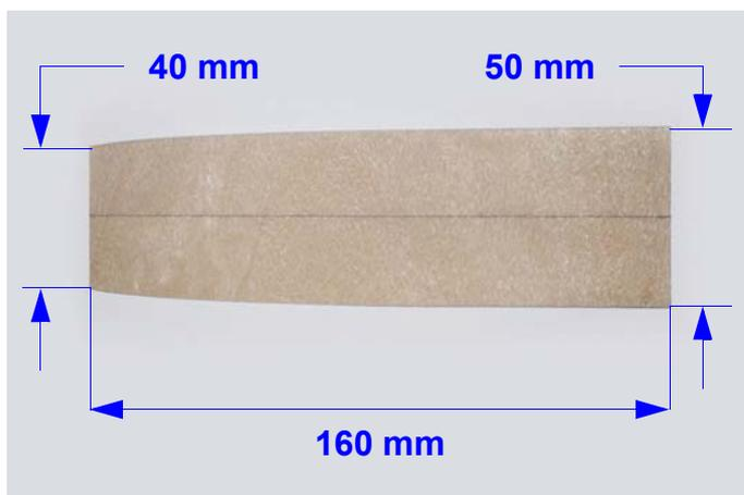
*Fig.12:Forma e dimensioni della basetta.*
