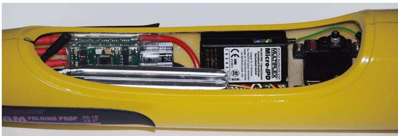
**Fig.47:Posizione dell'apparato ricevente.**
