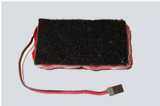
*Fig.17: Posizione del velcro sul pacco di batterie.*
