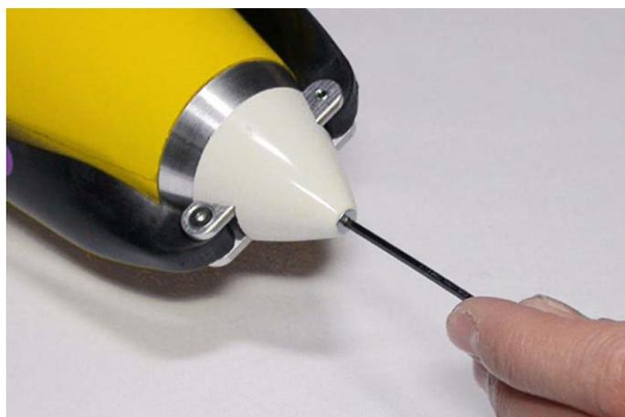
**Fig.29: Avvitare la vite di bloccaggio dell'ogiva.**
