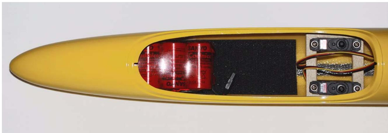
*Fig.18:Pacco batterie in posizione.*
