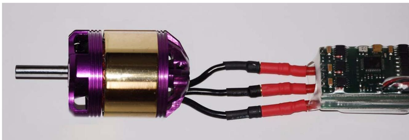
**Fig.22: Collegamento del motore brushless.**
