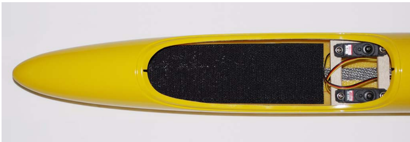
Fig.13: Posizionamento della basetta di supporto in fusoliera.
