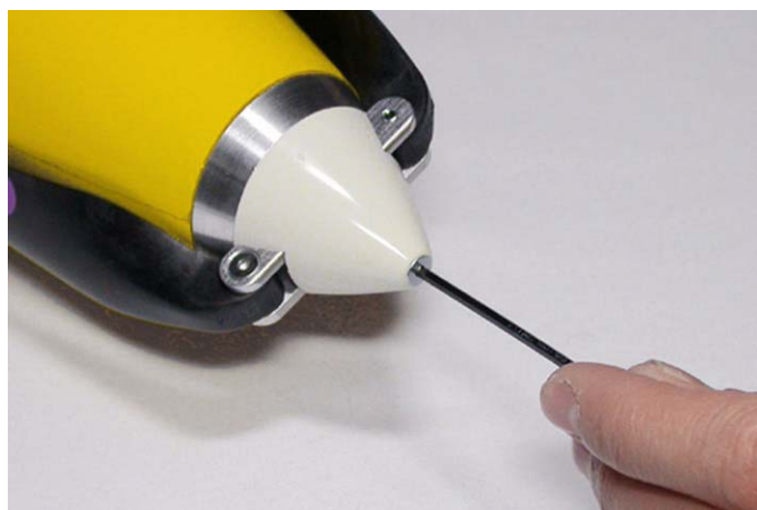
Fig.29: Avvitare la vite di bloccaggio dell'ogiva.
