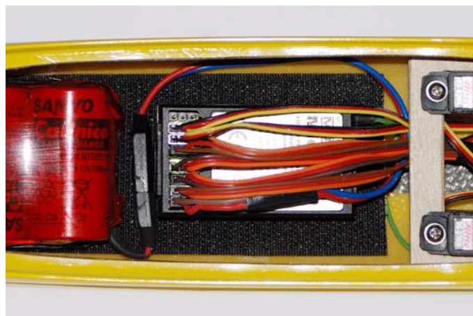
Fig.39:Collegare i connettori all'apparato ricevente.
