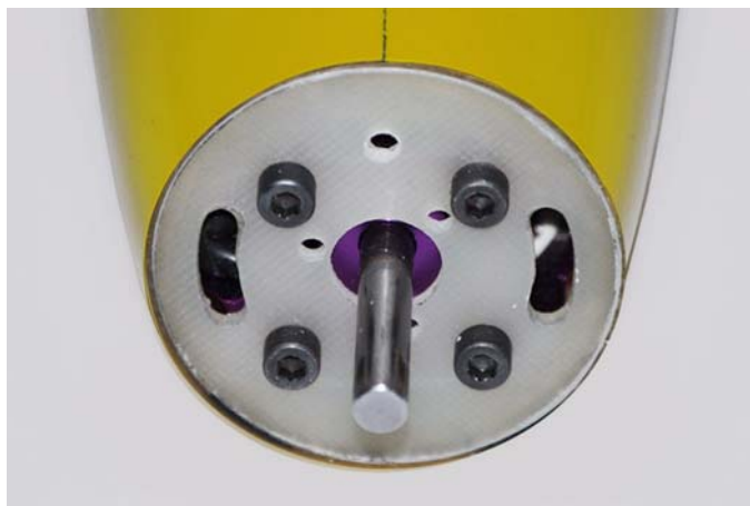
Fig.26: Viti di bloccaggio del motore.
