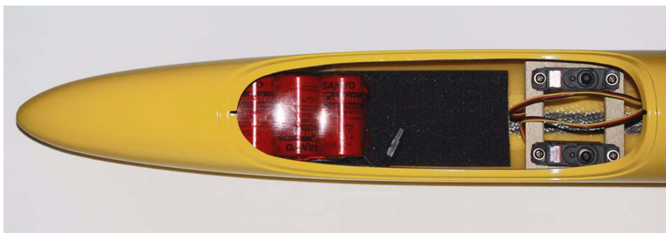
Fig.18: Pacco batterie in posizione.
