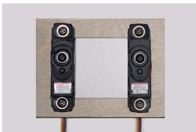
Fig.9: Posizione dei servocomandi nella basetta.
