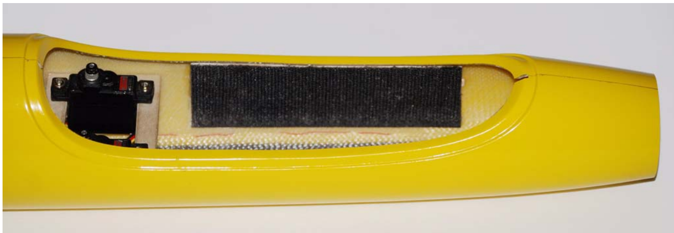
Fig.14: Velcro in posizione.
