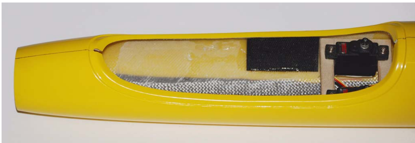
Fig.15: Posizione del velcro.
