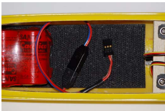
Fig.19: Connessioni del pacco di batterie.
