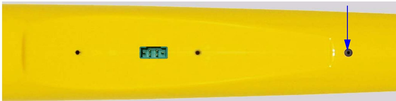
Fig.89: Posizione del foro per l'antenna.
