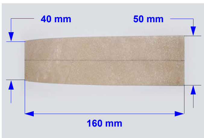
Fig.12:Forma e dimensioni della basetta.
