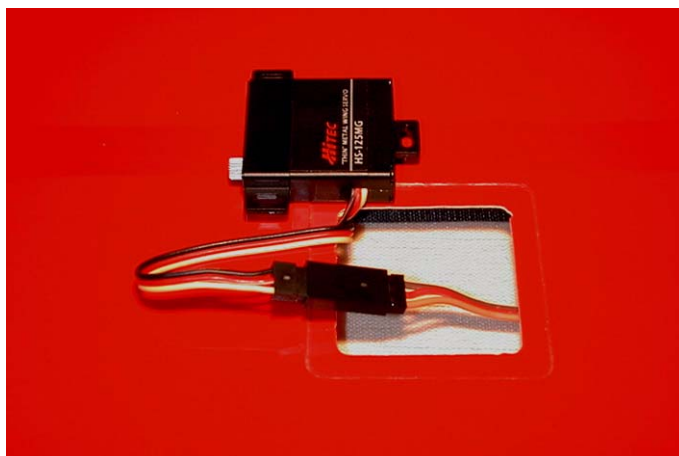
Fig.76:Collegamento tramite connettori UNI.
