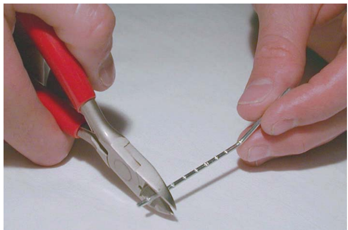
Fig.43: Incidere la parte non filettata dell'asta.
