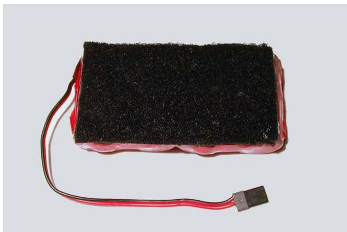
Fig.17: Posizione del velcro sul pacco di batterie.
