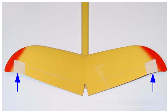
Fig.62: Tenere allineate le superfici mobili della coda.
