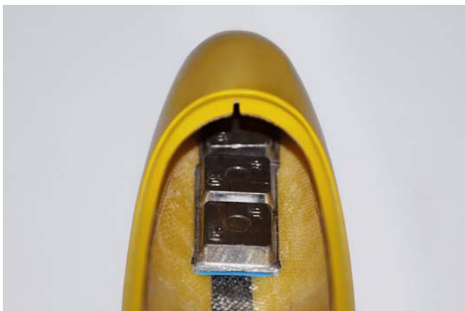
Fig.11:Posizionamento della zavorra.
