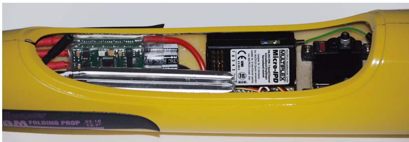
Fig.40:Posizione dell'apparato ricevente.
