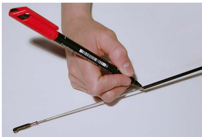
Fig.65:Segnare la posizione di inserimento dell'asta.
