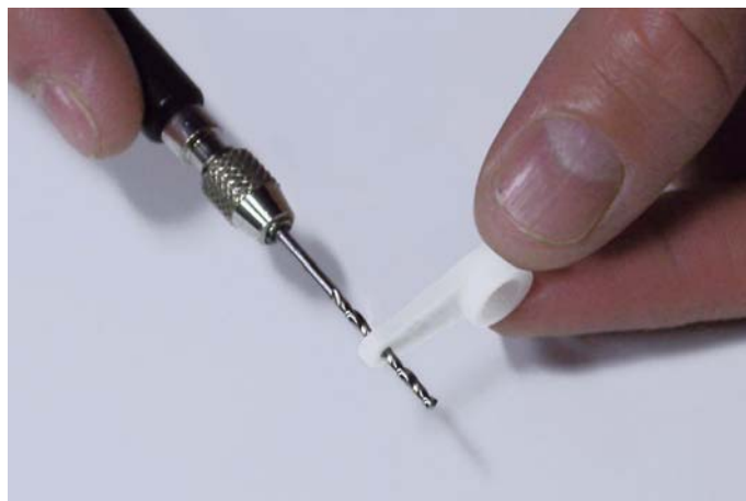
Fig.53: Allargare il foro della squadretta.
