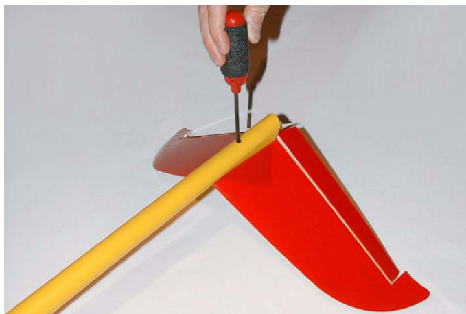
Fig.51:Fissare il piano di coda.
