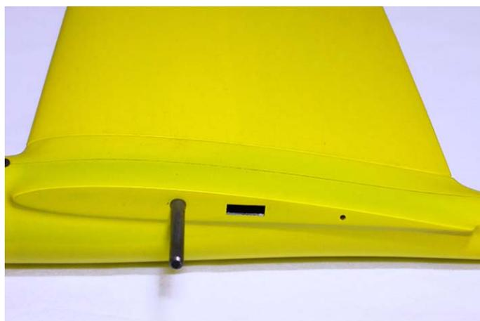
**Fig.39:** Infilare una semi-ala.
