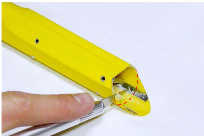
*Fig.7: Asportare la parte finale della fusoliera.*
