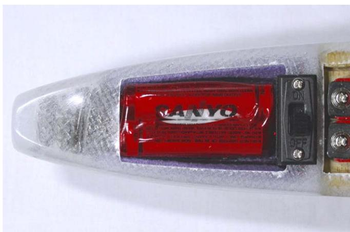
*Fig.25: Pacco batterie in posizione.*
