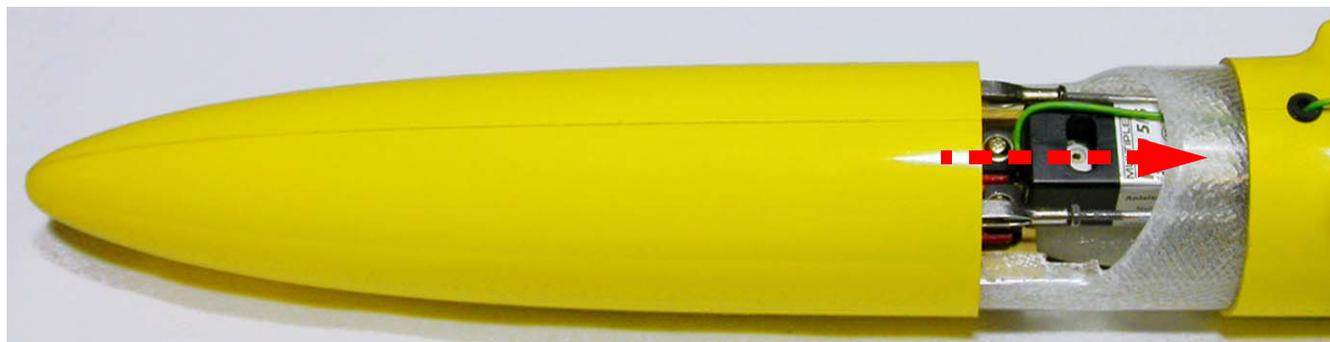
*Fig.101: Inserire il naso sulla fusoliera.*
