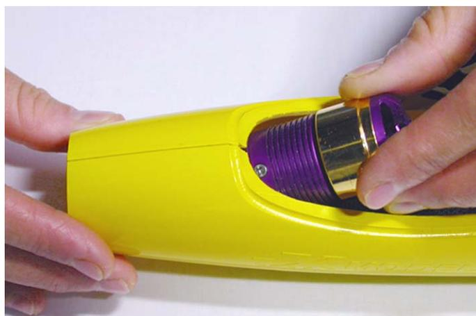
*Fig.59: Inserimento del motore in fusoliera.*
