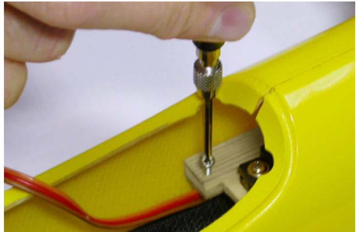
**Fig.55: Bloccare la basetta in posizione.**
