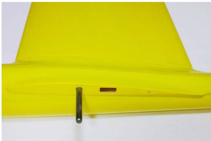
*Fig.21: Infilare la baionetta nell'alloggiamento.*
