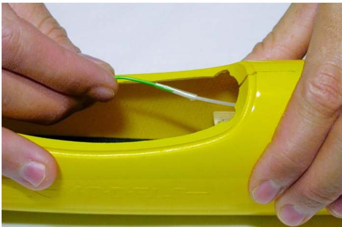
*Fig.33: Fissare i capi del filo di nylon e dell'antenna.*
