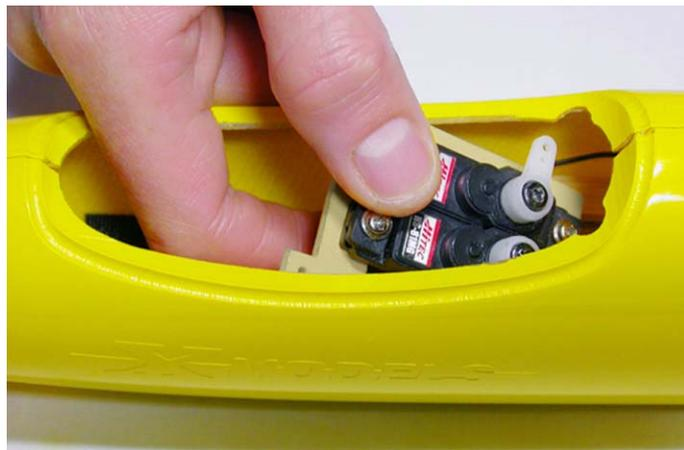
*Fig.42: Inserire la bassetta nelle guide.*
