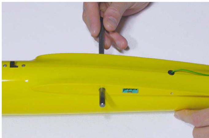
*Fig.99: Infilare la baionetta in fusoliera.*
