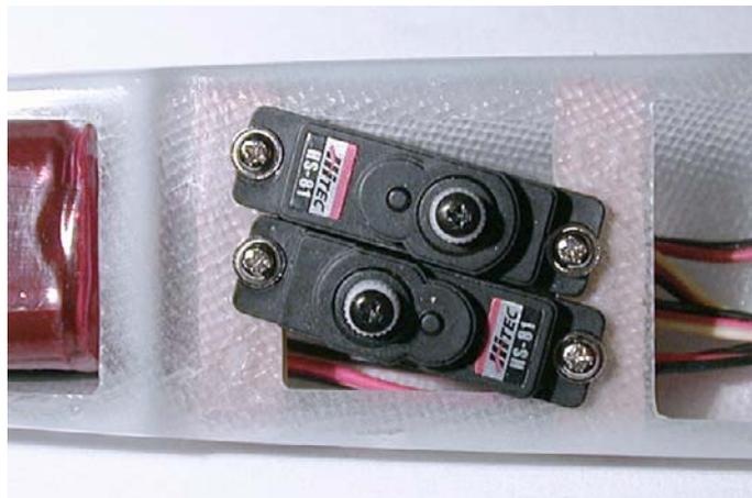
*Fig.20: Posizionamento dei servocomandi HS-81MG.*
