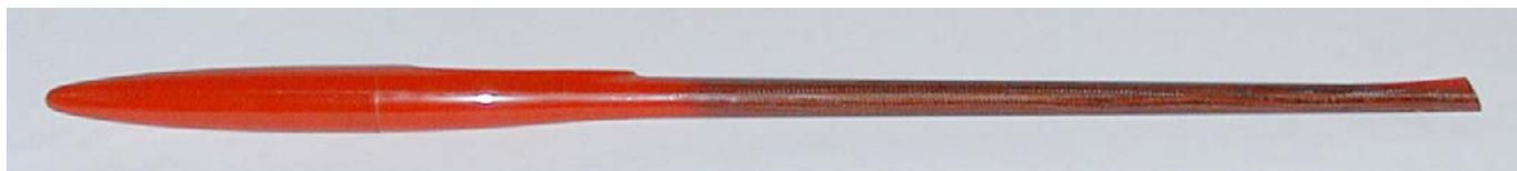
Fig.2:Fusoliera in fibra di carbonio.
