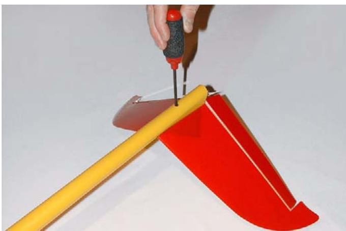
*Fig.43:Fissare il piano di coda.*
