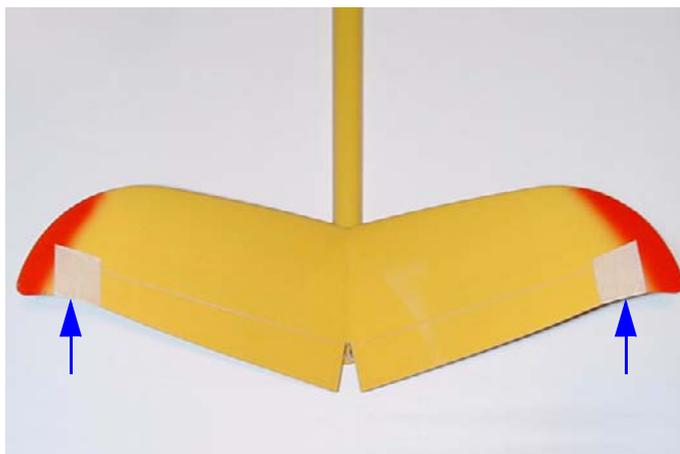
*Fig.50:Tenere allineate le superfici mobili della coda.*
