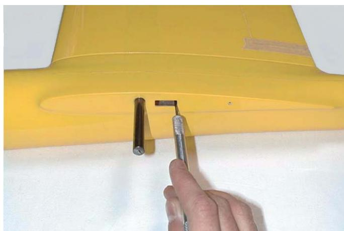
**Fig.43: Riportare il contorno del foro sull'ala.**
