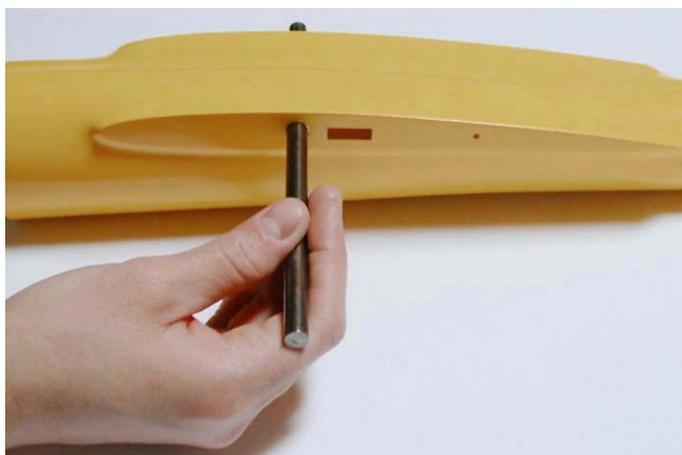
*Fig.41: Infilare la baionetta nell'alloggiamento.*
