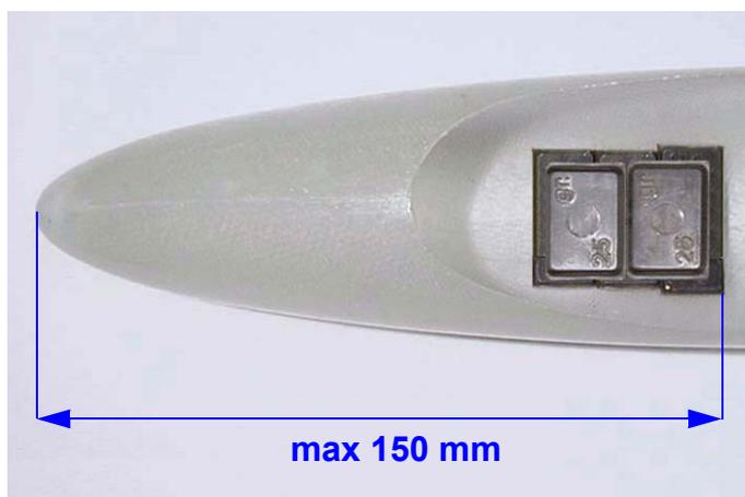
Questa è solo la parte fissa e fa da piano di appoggio per il pacco di batterie; il resto del piombo potrà essere aggiunto successivamente (durante il centraggio del modello) direttamente nella punta.
